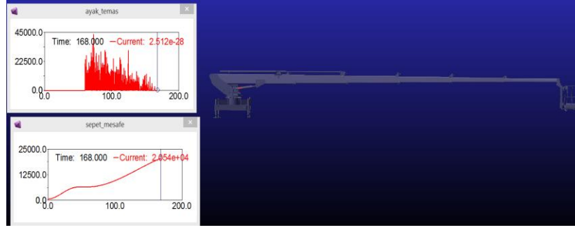
Şekil 8. Kule arkasında dengeleyici yük kullanılması makine yanal uzama kapasitesine etkisi
