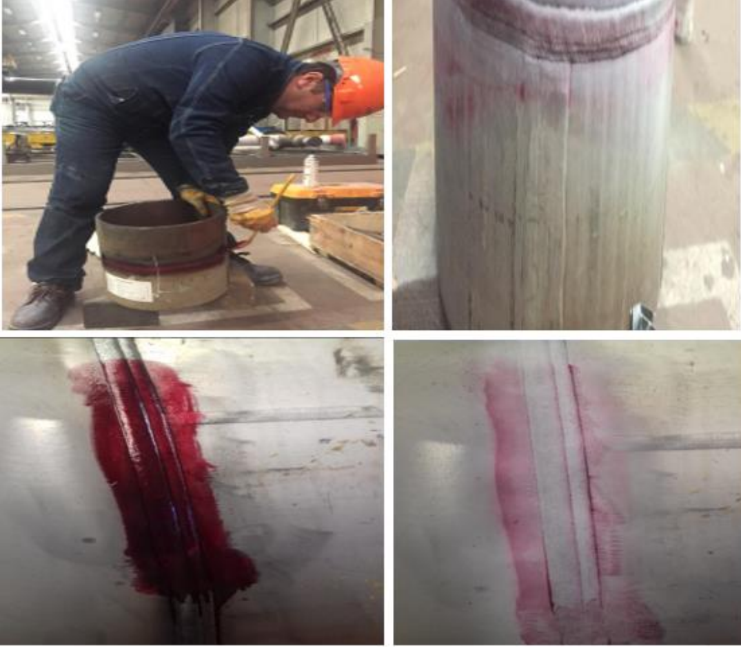
Şekil 3: Sıvı penetrant testi uygulaması şematik gösterimi
