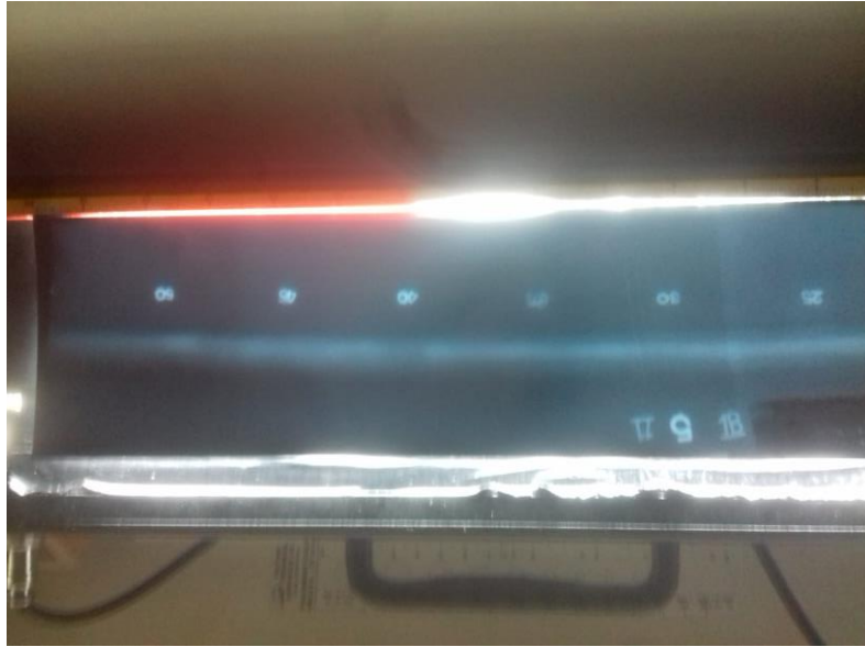
Şekil 5: Kaynaklı birleştirmeden alınan radyografik görüntü
